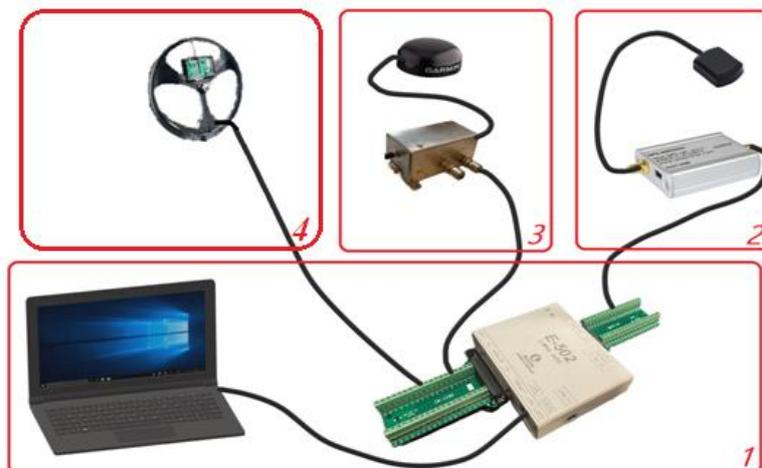
**Рисунок 3.** Блок-схема макета аппаратуры для регистрации сигналов СДВ диапазона.
