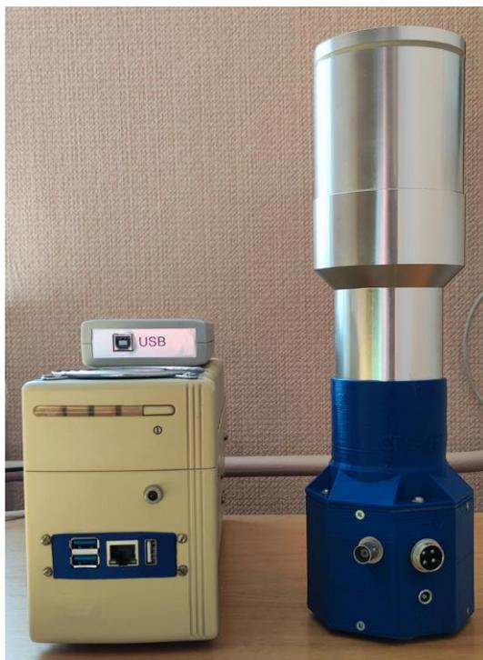
**Рисунок 1.** Общий вид портативного спектрометра. Справа: кристалл с ФЭУ в алюминиевом корпусе. В пластиковом корпусе основания находится предусилитель и высоковольтный делитель для ФЭУ. Слева: рабочий блок, в котором размещены блоки питания высокого и низкого напряжения, усилитель, дискриминаторы, GPS-приемник, мини-компьютер и прочие вспомогательные элементы. Приемная антенна для GPS на снимке не присутствует.
