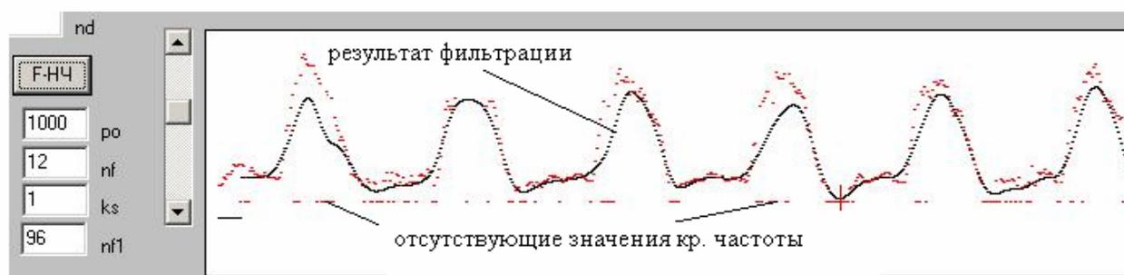
Рисунок 2. Фильтрация с помощью фильтра F-НЧ, частота среза  $f_2$ .
