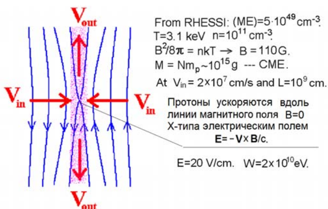
Рисунок 1. Вектора скорости плазмы и линии магнитного поля и в токовом слое при пересоединении линий магнитного поля. Поле Лоренца -\mathbf{V} \times \mathbf{B} направлено перпендикулярно плоскости рисунка.
